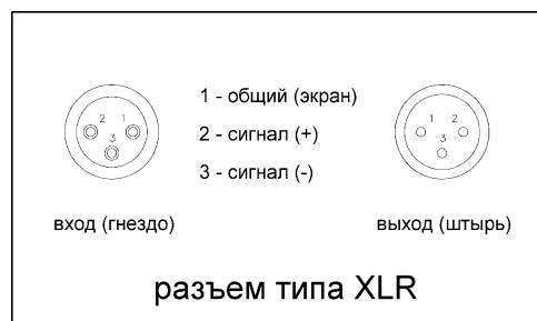
Рис.3. Функциональное назначение выводов разъемов XLR.
