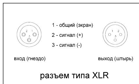
Рис.3. Функциональное назначение выводов разъемов XLR.
